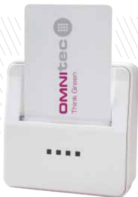
O modelo Smart distingue-se por ativar a instalação elétrica apenas quando é inserido um cartão MiFare específico associado à instalação. Os seus dois relés entram em funcionamento após o dispositivo ler e reconhecer a autorização atribuída ao hóspede ou colaborador.
